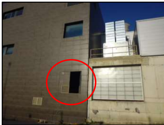
Foto 10: Puerta en entreplanta con riesgo caída >2,0m
